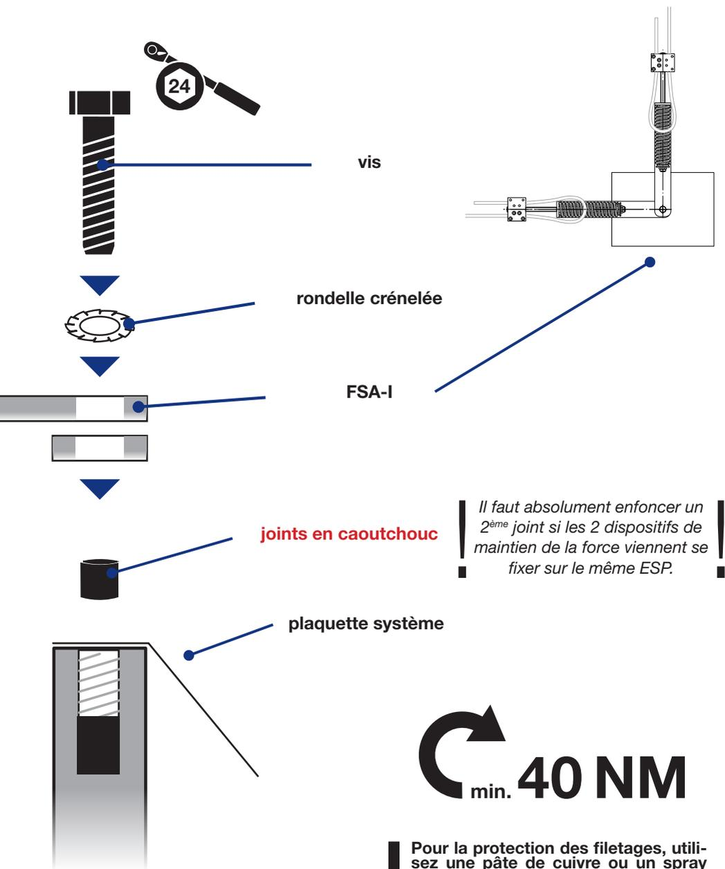
Il faut absolument enfoncer un 2<sup>ème</sup> joint si les 2 dispositifs de maintien de la force viennent se fixer sur le même ESP.
